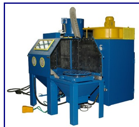
Камера КСО-110 НСФР с выдвижным поворотным столом
